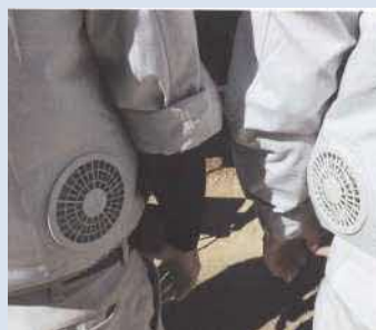
空調機能付きの作業服の活用
