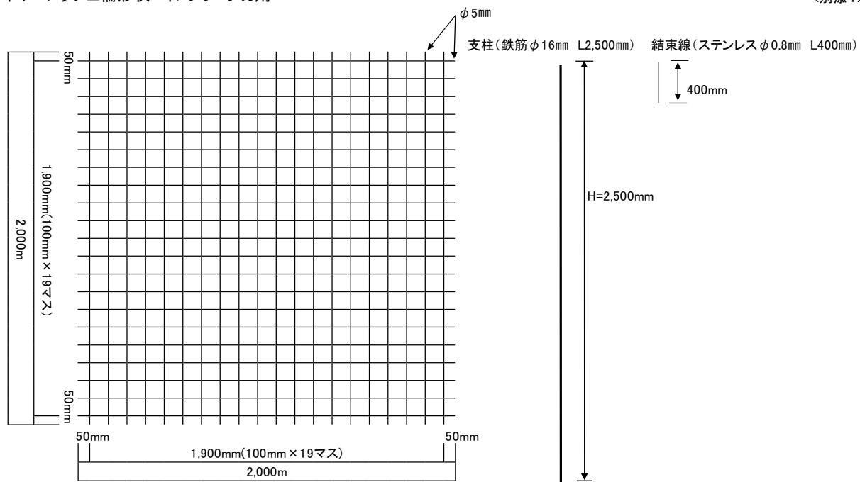
○ワイヤーメッシュ  $\phi 5\text{mm}$  2,000mm × 2,000mm 亜鉛メッキ(格子100mm × 100mm)
