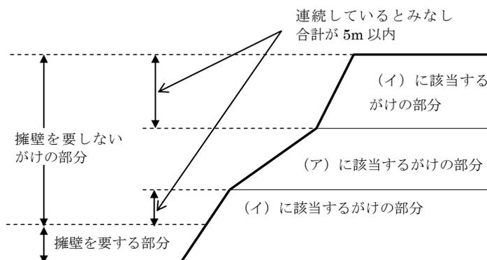
イ アの規定の範囲の適用については、小段などによって上下に分離されたがけがある場合において、下層のがけ面の下端を含み、かつ、水平面に対し30度の角度をなす面の上方に上層のがけ面の下端があるときは、その上下のがけを一体のものとしてみなす。
