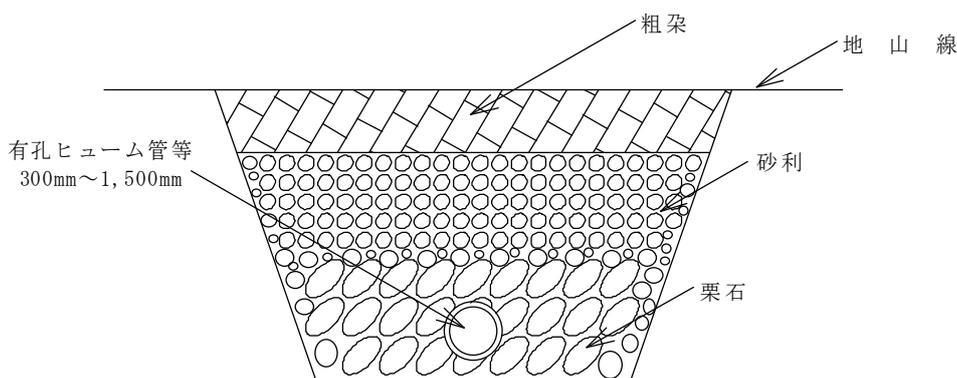
イ 常時流水のある場合は、流量算定のうえ断面を決定し、算定の結果60cm以下の場合でも60cm以上の管径をとること。
