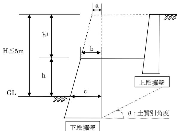
下段擁壁は、Hを擁壁の高さとし、擁壁の勾配及びc(下端部の厚さ)を決める。
