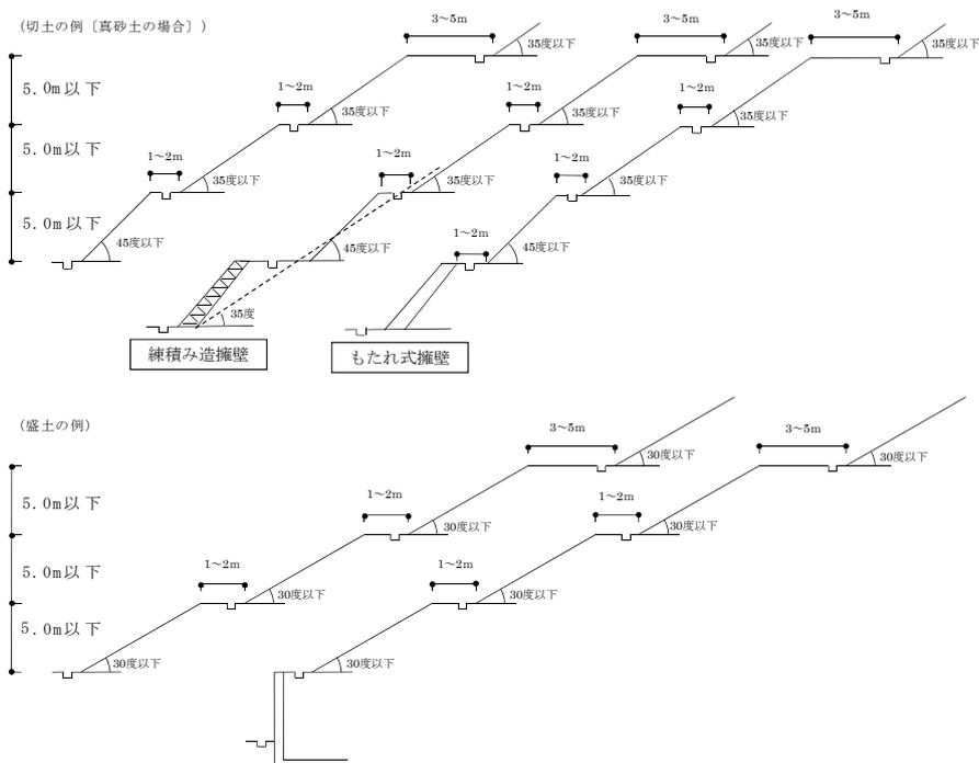
ウ のり面の上部に自然斜面が続いているなど、切土又は盛土のり面以外からの表面水が流下する場所には、のり肩排水溝を設けること。
